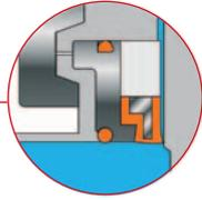
**Étanchéité de manchon avec noyau métallique** pour le meilleur effet isolant dynamique et statique grâce à une tension préalable définie. Positionnement de tous les éléments d'étanchéité avec butée métallique - sans espace mort
