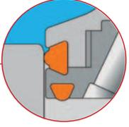
**Sièges de clapets divisés** pour la réception de l'étanchéité du clapet de la vanne. Une pénétration par l'arrière de l'étanchéité du clapet de la vanne est entièrement évitée.
