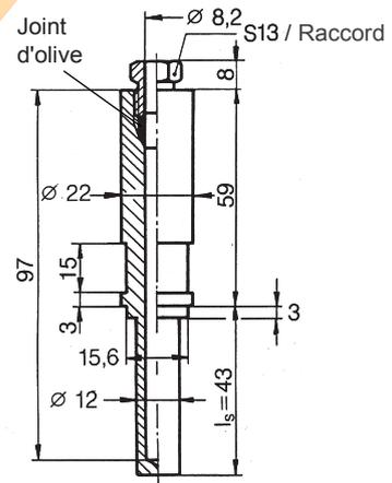
Exécution pour tuyauteries calorifugées et thermomètres avec profondeur de plongée min. < 60 mm
