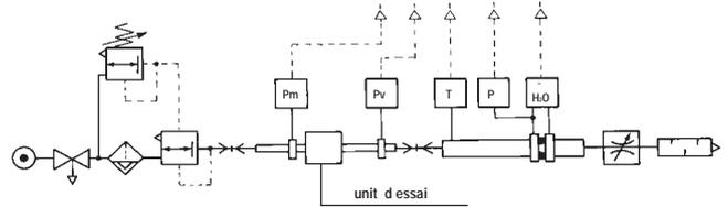
• Tests de débit effectués par le Département de Mécanique de l'École Polytechnique de l'Université de Turin en utilisant le banc de mesure avec ordinateur et en suivant les indications de la recommandation CETOP RP50R (acceptée par l'ISO DIS 6358-2) avec mètre à diaphragme ISO 5167.
