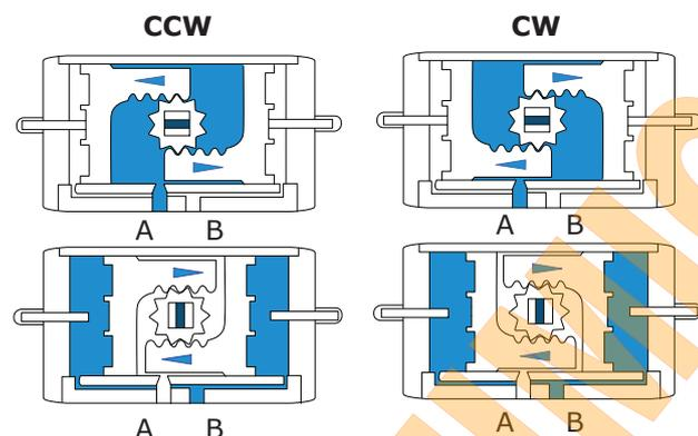
**CCW:** L'air entrant dans le port A force les pistons vers l'extérieur, entraînant un mouvement du pignon dans le sens des aiguilles d'une montre pendant que l'air est expulsé par le port B.
