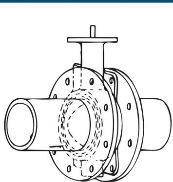
Placez soigneusement la vanne papillon entre les brides, avec le disque en position fermée.
