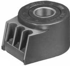
Ces bobines sont conçues pour les valves Lucifer à commande par impulsion. Elles sont montées généralement avec le boîtier Lucifer 4269 ou 4538. L'enroulement est entièrement enrobé de matière synthétique. Montage simple et facile. Raccordement électrique avec serre-fils pour section jusqu'à 1.5 mm<sup>2</sup>.
