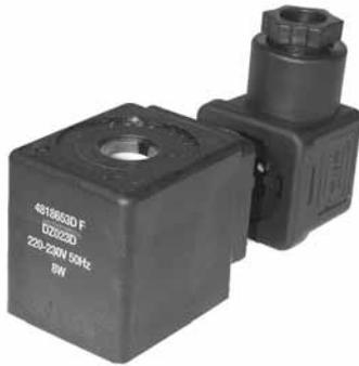
Cette bobine miniature montée avec une fiche DIN est compatible uniquement avec les électrovalves Lucifer pour application basse puissance (miniwatt). Elle se compose d'un enroulement et d'une armature métallique, le tout entièrement enrobé de matière synthétique. Cet enrobage offre une protection efficace contre les contacts fortuits ainsi qu'une bonne étanchéité. Montage facile dans les endroits peu accessibles.
