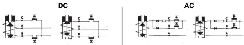
Dès qu'une impulsion électrique est donnée aux bornes du circuit A-B, la force magnétique attire le noyau mobile et simultanément donne une aimantation permanente à un anneau magnétique. C'est cette force magnétique qui retient le noyau dans sa position. Des impulsions ultérieures, l'enclenchement permanent ou une coupure du courant ne changent pas cette position.
