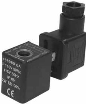
Ces bobines miniatures sont compatibles avec la grande majorité des électrovalves Lucifer série 2000. Elles se composent d'un enroulement et d'une armature métallique, le tout entièrement enrobé de matière synthétique. Cet enrobage offre une protection efficace contre les contacts fortuits ainsi qu'une bonne étanchéité. Montage facile dans les endroits peu accessibles.
