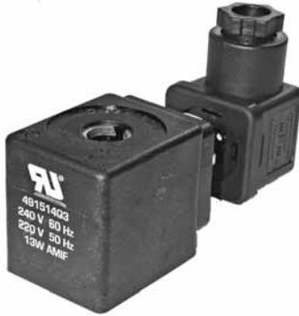
Cette bobine miniature est compatible avec la grande majorité des électrovalves Lucifer. Elle est couverte dans un système d'isolation classe F reconnu UL. Elle se compose d'un enroulement et d'une armature métallique, le tout entièrement enrobé de matière synthétique. Cet enrobage offre une protection efficace contre les contacts fortuits ainsi qu'une bonne étanchéité. Montage facile dans les endroits peu accessibles.
