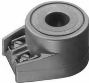
Ces bobines sont compatibles avec la grande majorité des électrovalves Lucifer. Elles peuvent être montées avec la grande majorité des boîtiers métalliques Lucifer. L'enroulement est entièrement enrobé de matière synthétique. Montage simple et facile. Raccordement électrique avec serre-fils pour section jusqu'à 1.5 mm"
