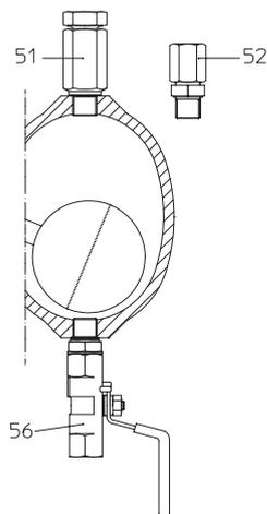
Robinet à tournant sphérique pour fonction: robinet de purge (limité jusqu'à 16 bar, 210°C)
