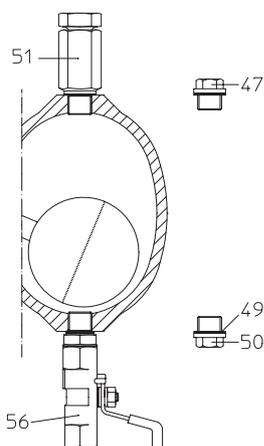
Robinet à tournant sphérique pour fonction: robinet de purge (limité jusqu'à 16 bar, 210°C)
