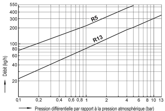
Ce diagramme montre le débit maxi. d'eau chaude du purgeur à flotteur fermé.
