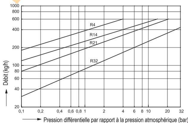
Ce diagramme montre le débit maxi. d'eau chaude du purgeur à flotteur fermé.
