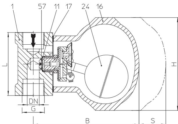
Fig. 634...2 (PN16/25) à manchons taraudés - montage vertical
