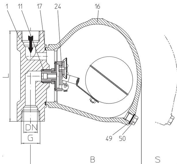
Fig. 635...2 à manchons taraudés - montage vertical
