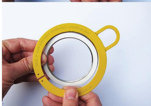
Chaque élément d'étanchéité est associé à un anneau guide économique, adapté aux dimensions de la norme de bride utilisée. L'anneau guide, d'une épaisseur de 2,5 mm, est fabriqué soit à partir d'acier inoxydable de qualité 304 soit à partir d'acier au carbone. Il est façonné comme un anneau discontinu dans le sens circonférentiel. Il peut ainsi être plié pour permettre un remplacement facile de l'élément d'étanchéité qu'il contient.
